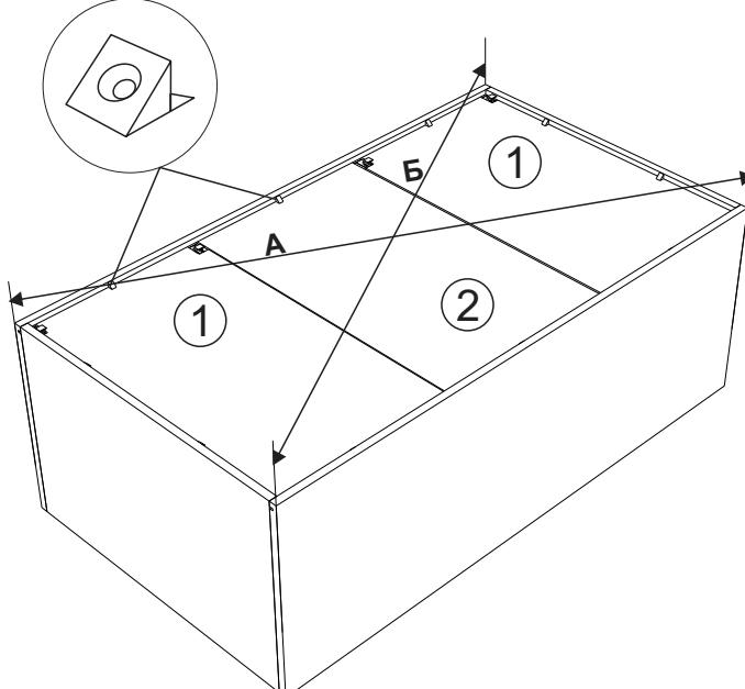
4. Закрепите монтажную шину к стене (крепеж в комплект не входит) навесьте собранный шкаф, отрегулируйте положение шкафа по высоте и глубине регулировочными винтами навесов. Затем закрепите к створкам с помощью шурупов 4x16 петли и прикрепите створки к ответным планкам петель на боковины шкафа, отрегулируйте и выставьте зазоры согласно схеме. Установите стеклополки №2 и полки №4 как показано на схеме 3.
