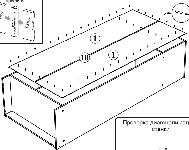
4. Для крепления задней стенки изделие необходимо положить на ровную поверхность лицевой стороной вниз, после чего закрепить задние стенки 1 к каркасу, используя гвозди, предварительно выровняв диагональ при помощи рулетки, и соединив детали 1 профилем 10.
