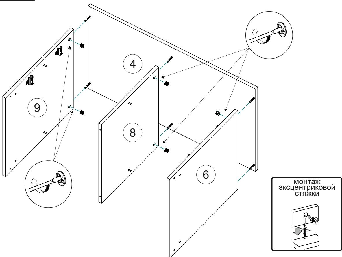
**4.** Евровинтами закрепите вязку 7 к боковинам 6,9 и перегородке 8. Переверните изделие лицевой стороной вниз. С помощью рулетки уравняйте диагонали А и Б, затем, не нарушая диагоналей, гвоздями закрепите задние стенки (ЛДВП).
