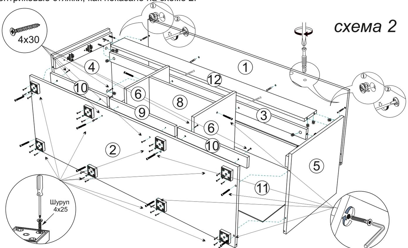
4. Установите тумбу на место. Закрепите петли на створках. Створка №13 крепится к планке №3 прикрепленной к боковине №4 а створка №14 к планке №3 прикрепленной к боковине №5. Зазоры отрегулируйте по схеме.
