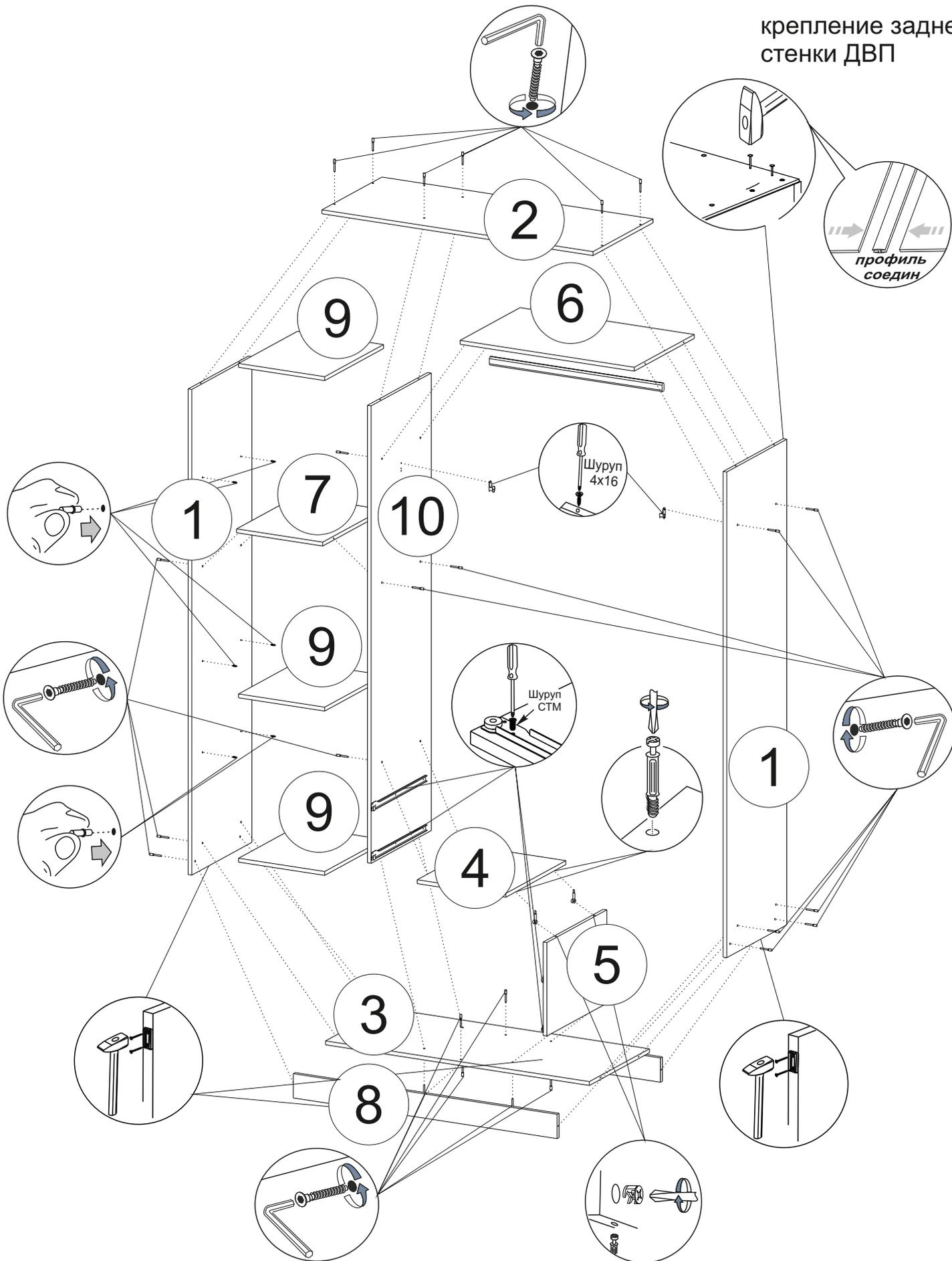
*Перед началом сборки закрепите подпятники с помощью гвоздей и скалкодержатели шурупами 4x16 к боковинам 1, а также роликовые направляющие шурупами СТМ.*
