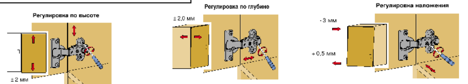
Рис.3 Схема установки петель
