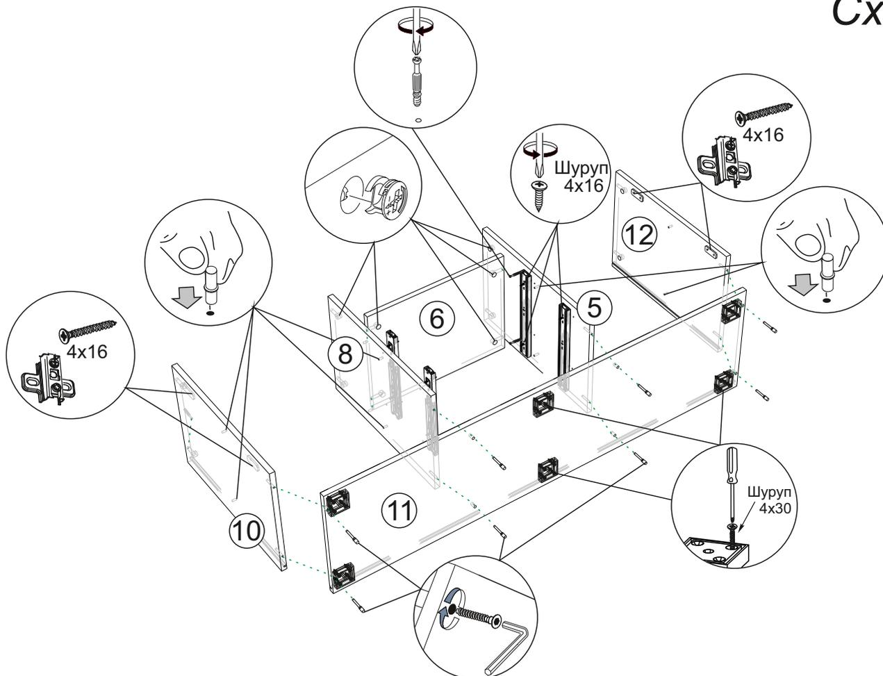
3. Установите тумбу в вертикальном положении. Вставьте в пазы задние стенки №2 последовательно, соединив между собой соединительным профилем №18. Затем закрепите крышку №3. Переверните собранную тумбу лицевой стороной вниз, проверьте с помощью рулетки диагонали, уровняйте их и аккуратно, с помощью шурупов 4x16 и уголков RV8, закрепите задние стенки к корпусу тумбы как показано на схеме 2.
