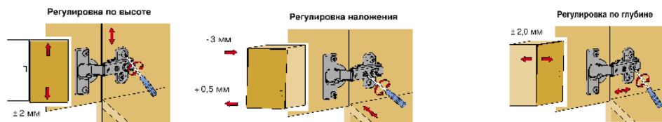
Рис.3 Схема регулировки петель
