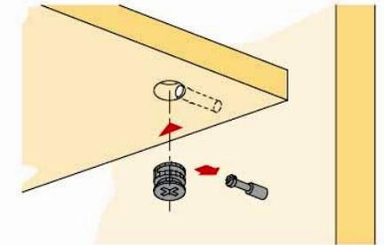
Рис.2 Схема установки эксцентриковой стяжки
