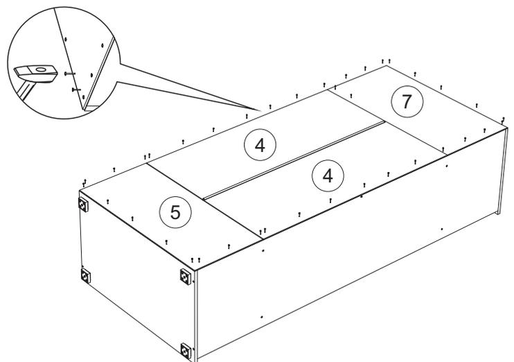
**5. Закрепите карниз на верхнюю крышку с использованием шурупов 4x25 и пластиковых шайб**
