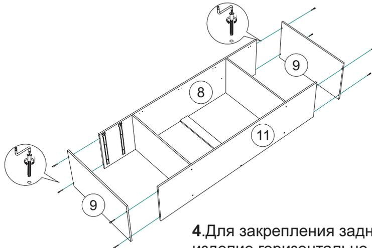
4. Для закрепления задних стенок положите изделие горизонтально, лицевой стороной вниз. Далее следует выровнять диагональ при помощи рулетки, после чего закрепить панели №4, №5, №7 гвоздями, предварительно соединив панели 4 профилем.
