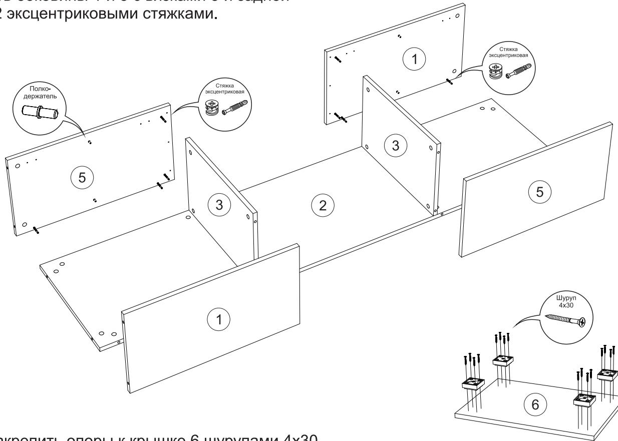
**3)** Закрепить опоры к крышке 6 шурупами 4x30.
