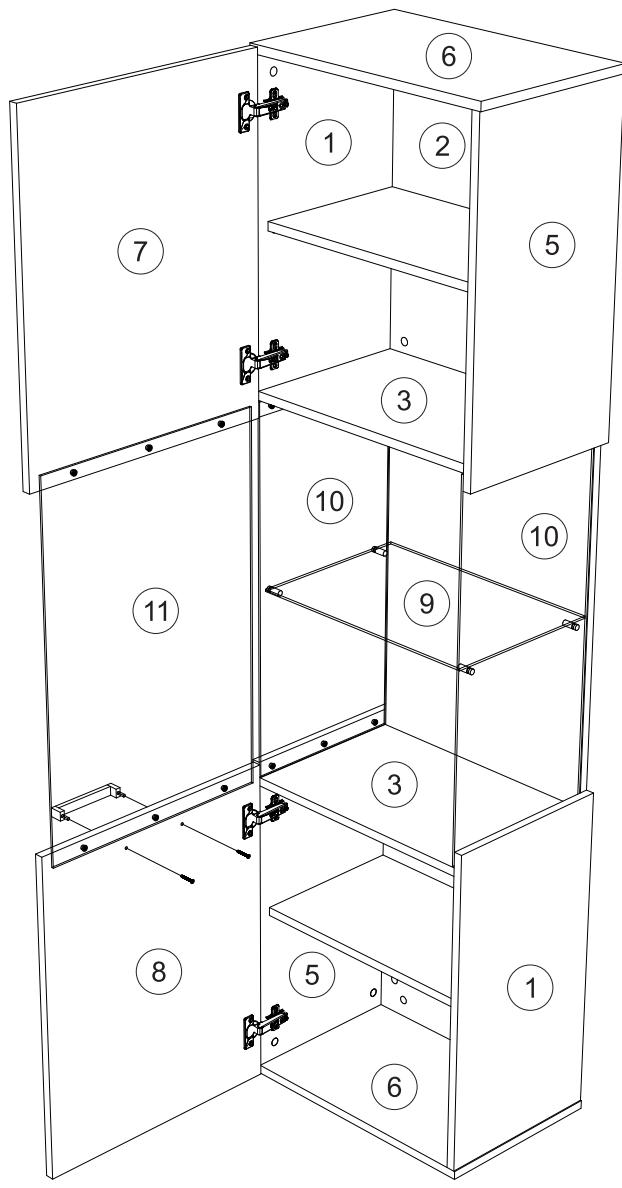
схема монтажа петли
