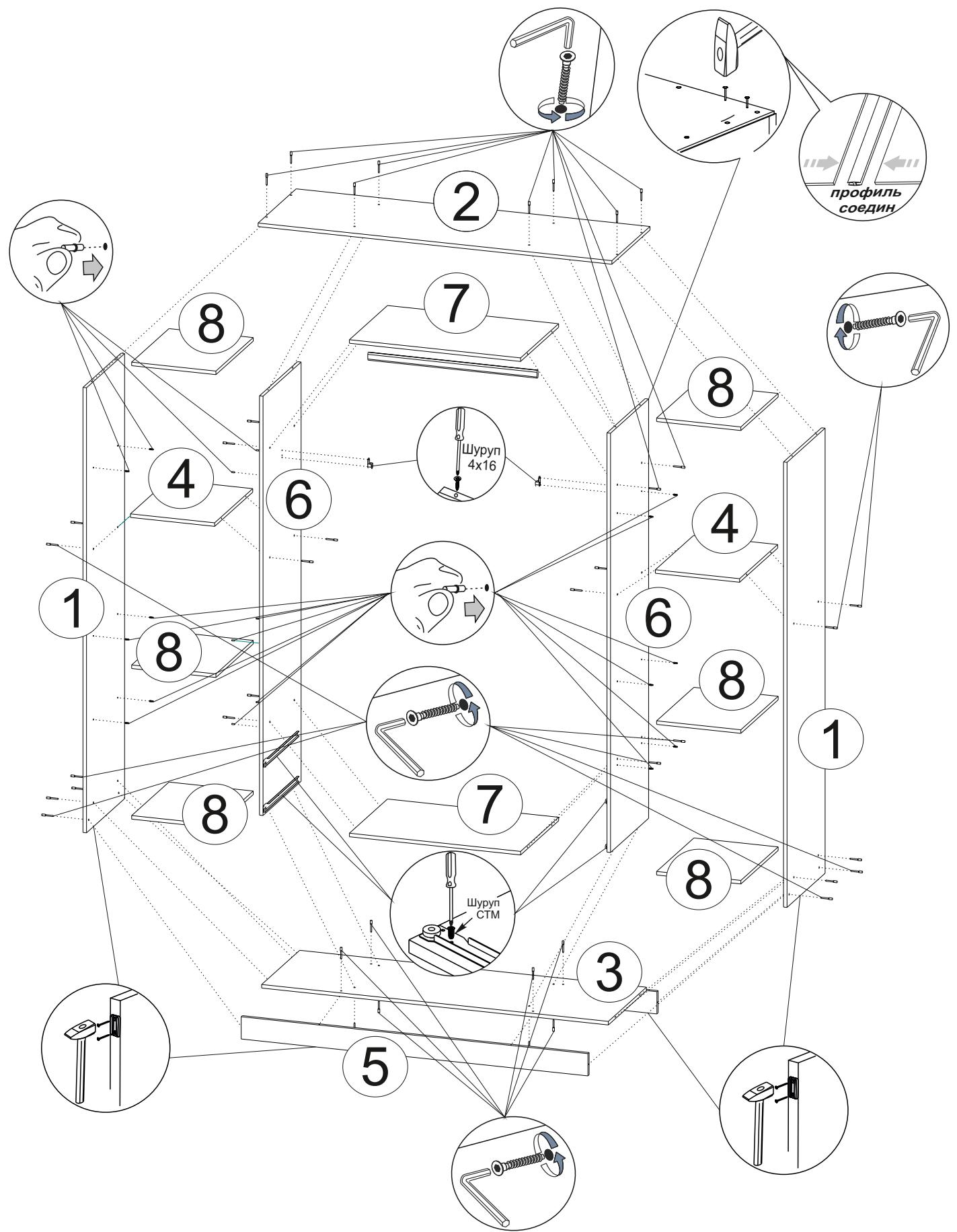
*Перед началом сборки закрепите подпятники с помощью гвоздей и скалодержатели шурупами 4x16 к боковинам 1, а также роликовые направляющие шурупами СТМ к перегородкам.*
