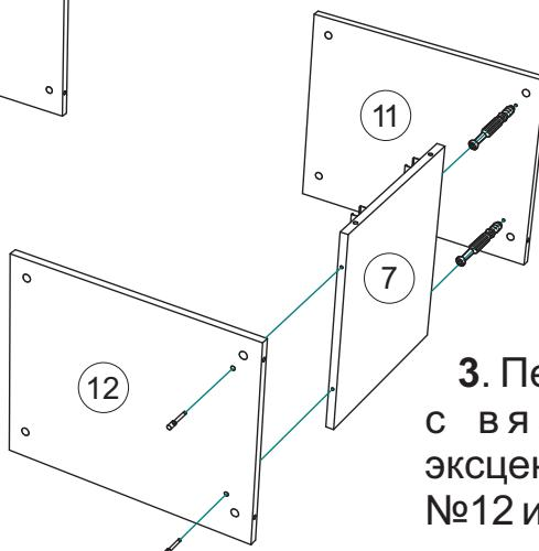
3. Перегородки №6, №7 соедините с вязками №11 используя эксцентриковые стяжки, а с вязками №12 используя евровинты.
