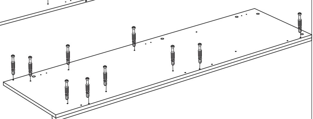
**8 Соедините эксцентриковыми стяжками боковины №1, №2 с задними стенками №4, вязками №11, №12 и цоколем №16.**
