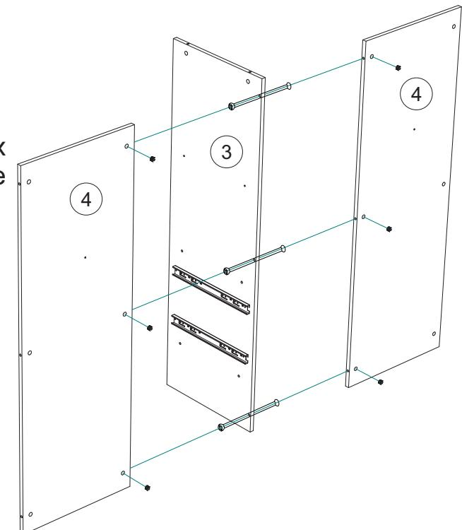
4. С помощью двойных эксцентриковых стяжек через перегородку №3 соедините задние стенки №4.
