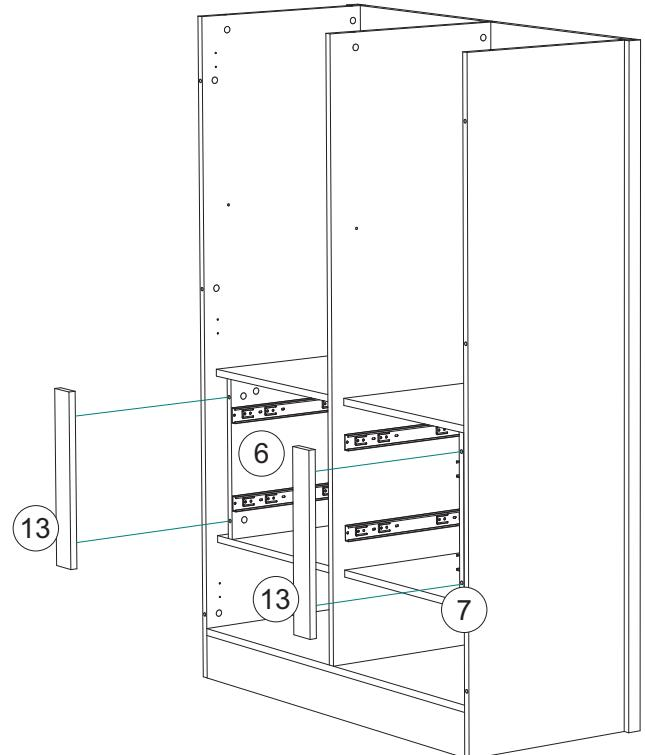
**9 Планки №13 соедините эксцентриковыми стяжками с перегородками №6, №7.**
