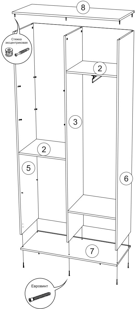
6. Соединить боковины 5, 6 и перегородку 3 с вязками 2 эксцентриковыми стяжками, как показано на схеме, предварительно вставив задние стенки 1 в соответствующие пазы.
